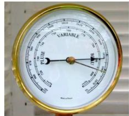
Baromètre : appareil de mesure de pression atmosphérique
